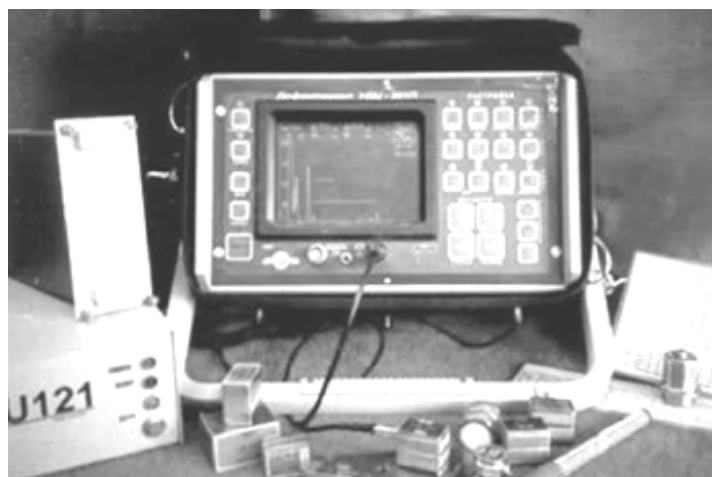
Рис. 9.8. Процессорный дефектоскоп общего назначения
