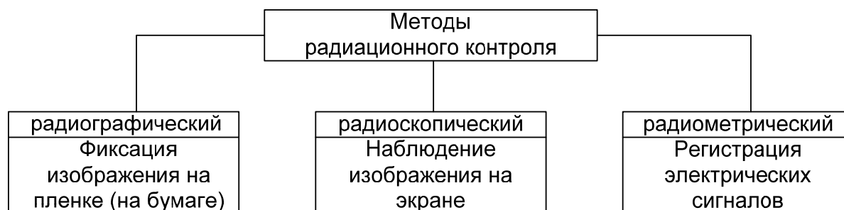
Рис. 4.6. Классификация методов радиационного контроля
